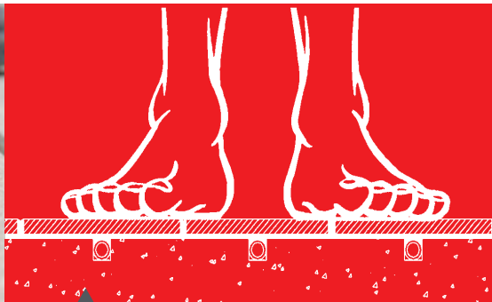
Verwarmingsbuizen direct onder de vloerafwerking voor een snelle opwarming en een nauwkeurige regeling.
