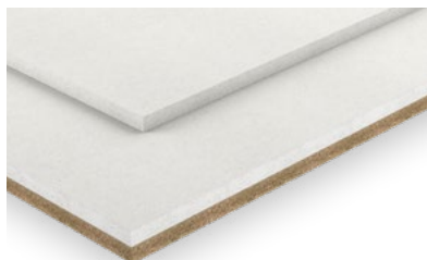
Plaque de sol fermacell® avec couche de fibres de bois de 10 mm (30 ou 35 mm d'épaisseur)
