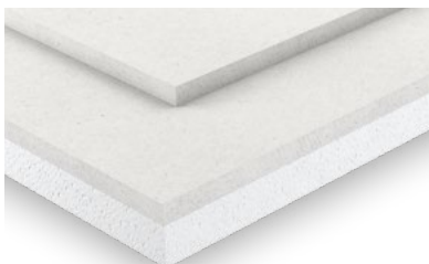
Plaque de sol fermacell® avec couche de polystyrène¹ de 20 ou 30 mm (40 ou 50 mm d'épaisseur)
