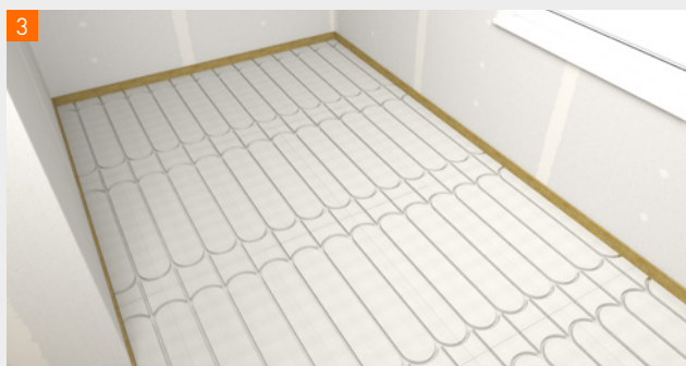
Couvrez l'ensemble de l'espace au moyen de plaques de sol fermacell® Therm25™.
