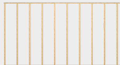
Entraxe de la sous-structure, max. 500 mm
