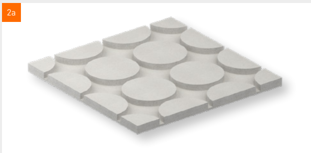
fermacell® Therm25™ Élément de chauffage par le sol rond, élément supplémentaire pour fermacell® Therm25™ pour les petites surfaces, portes, etc. avec un espacement de 167 mm.
