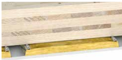
Sol en bois massif CLT avec plafond sous solive avec profilé à ressort
