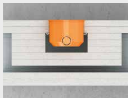
Pour des murs sans matériau isolant, les prises, boîtes de commutation et de dérivation doit être entièrement enveloppées de plaques fibres-gypse fermacell d'une épaisseur égale aux plaques du mur.
