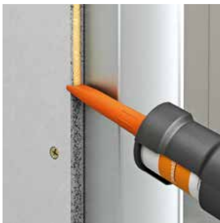
Joint collé fermacell - largeur de joint : 0,5 - 1 mm
