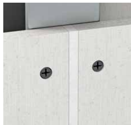
Joint d'enduit fermacell – largeur de joint : \frac{1}{2} \times épaisseur de plaque
