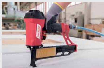
Figure 1 : Fixation manuelle par agrafeuse pneumatique
