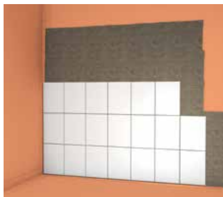
Illu. 7 : Les carrelages sont posés dans une mince couche de Mortier-colle flexible fermacell sur un film d'étanchéité en pleine surface (ce qui garantit l'étanchéité pour la classe de contrainte hydrique A).
