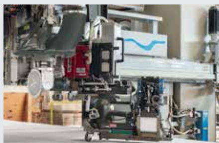
Figure 2 : Fixation mécanique par agrafeuse industrielle
