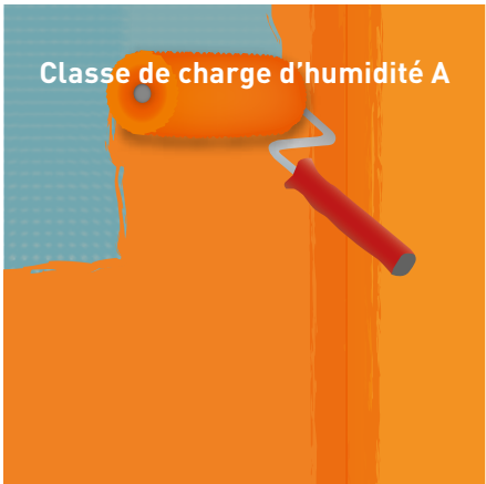
Illu. 5 : Appliquer au rouleau Sous-couche de protection à l'eau fermacell , en 2 couches, sur la totalité de la surface [épaisseur totale de l'enduit de couverture : 0,5 mm au moins].
