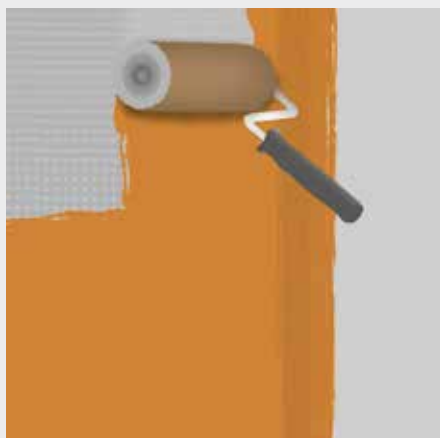
Fig. 5 : Appliquer le Sous-couche de protection à l'eau fermacell au rouleau en 2 passes sur toute la surface (épaisseur totale d'au moins 0,5 mm).
